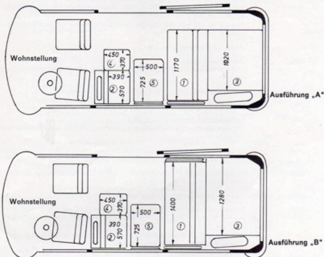
Einbausatz für VW-Kombi und VW-Achtsitzer bzw. VW-Achtsitzer L ab Baujahr 1968. Dieser herausnehmbare Einbausatz ist nicht für Fahrzeuge geeignet, die eine durchgehende Trennwand besitzen, also den Durchgang Fahrerhaus/Fahrgastraum nicht aufweisen.
